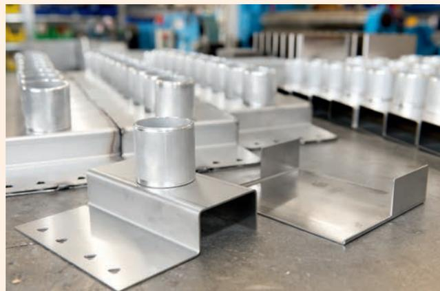
Bei der Fertigung unserer Einblasdüsen verwenden wir nur rostfreies Material. Nach einer kompletten Handverschweißung werden die Oberflächen mit einer Glasperlenbestrahlung veredelt.
